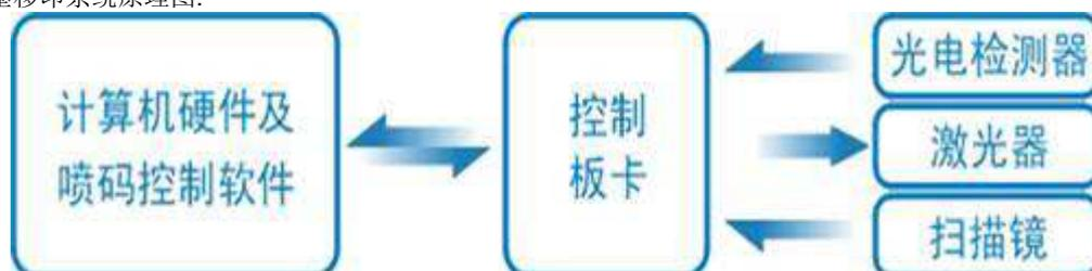
工作原理：用激光油墨移印控制软件制作图案、文字、数字、序列号等标刻内容，以及对激光器、扫描镜的调节及参数控制，光电检测器的信号经计算机计算处理后，输出数字信号。由控制板卡将数字信号转换为模拟信号，用来控制激光器的出光和扫描镜转动的角度，从而达到标刻的目的。
